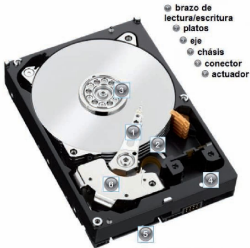
Figura 1.8. Disco duro de varios platos.
