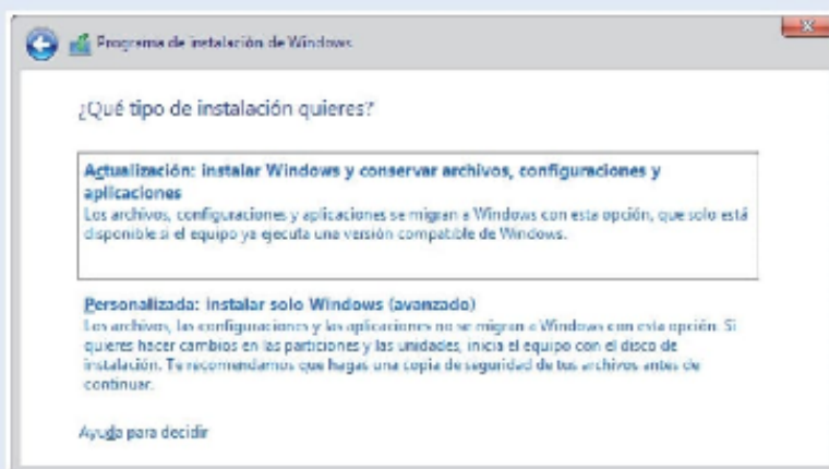
Figura 5.10. Selección del tipo de instalación.
